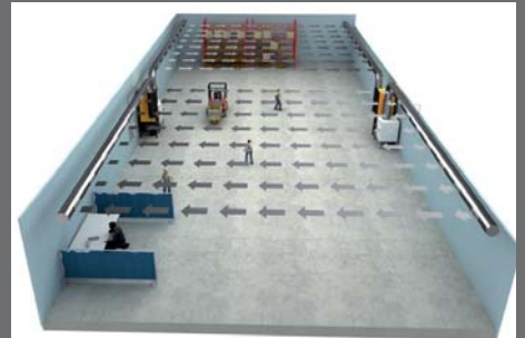
Suora Push/Pull-järjestelmä, jossa 2 suodatinyksikköä ja 2 puhallinta
