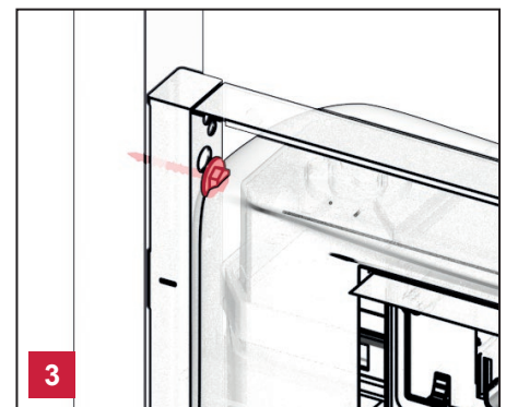
3 Kiinnitä teline neljällä ruuvilla. Käytä kyseiseen runkorakenteeseen soveltuvia ruuveja.
