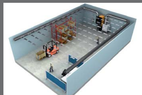
U-muotoinen Push/Pull-järjestelmä, jossa 1 suodatinyksikkö ja 1 puhallin
