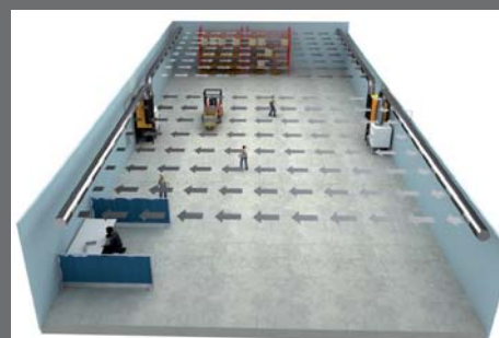
Suora Push/Pull-järjestelmä, jossa 2 suodatinyksikköä ja 2 puhallinta
