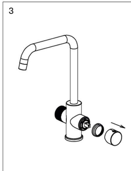
KUVA 3 | BILD 3 | IMAGE 3 FI Vedä käyttökahva ja koristeholkki pois. SE Ta bort handtaget och täckhylsan. EN Remove the handle and the cover sleeve.
