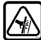
**HOPPER SUPPORT BAR LABEL - LOCATED ON THE HOPPER LIFT ARMS CROSS-TUBE AND ON BOTH HOPPER LIFT ARMS.**
