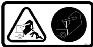
**HOPPER LIFT ARMS LABEL - LOCATED ON BOTH HOPPER LIFT ARMS.**
