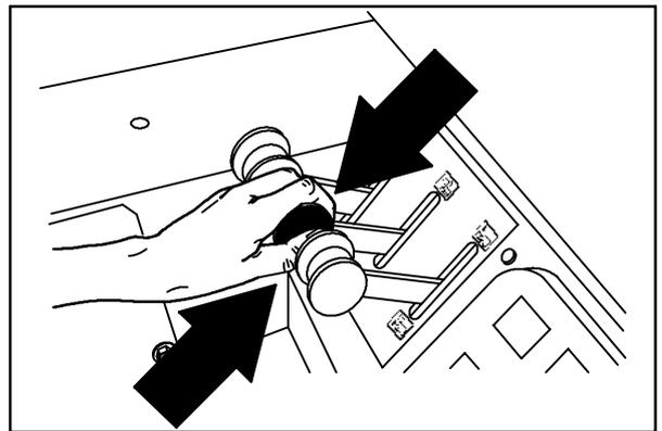
In: Push and hold the hopper rollout lever in the **In** position.
